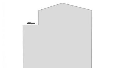
Étage supérieur d'un édifice construit en retrait par rapport au plan de la façade, et en général de façon plus légère.
